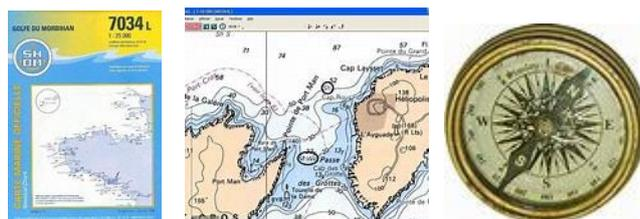
La carte s'oriente à l'aide de la rose des vents qui y figure (N, S, E, O). Cette rose informe de la déclinaison magnétique qui est une légère différence en degrés entre le nord vrai et le nord magnétique qu'indique une boussole.
